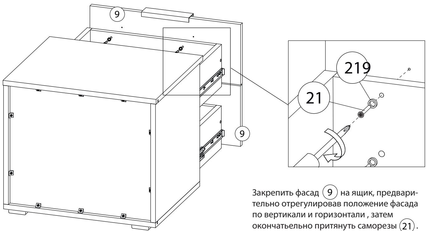
Закрепить фасад **9** на ящик, предварительно отрегулировав положение фасада по вертикали и горизонтали , затем окончательно притянуть саморезы **21** .
