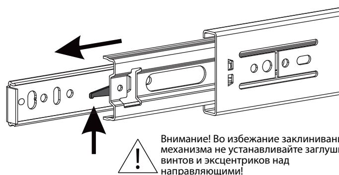
**Схема установки шариковых направляющих.**
