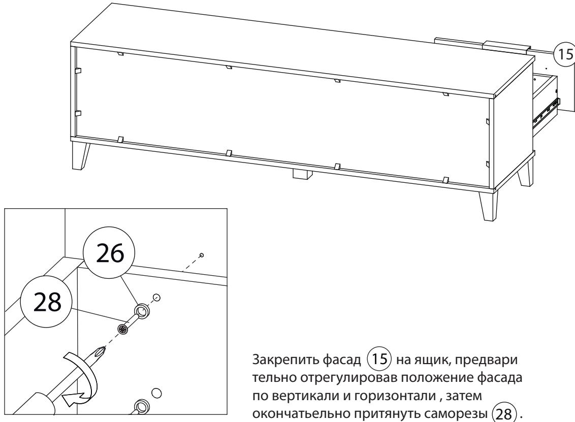
Закрепить фасад **(15)** на ящик, предварительно отрегулировав положение фасада по вертикали и горизонтали , затем окончательно притянуть саморезы **(28)**.
