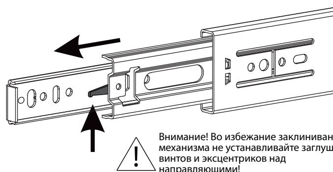
**Схема установки шариковых направляющих.**
