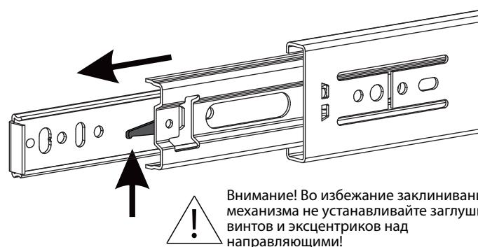
**Схема установки шариковых направляющих.**
