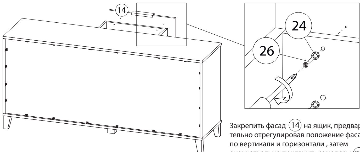
Закрепить фасад (14) на ящик, предварительно отрегулировав положение фасада по вертикали и горизонтали , затем окончательно притянуть саморезы (26) .
