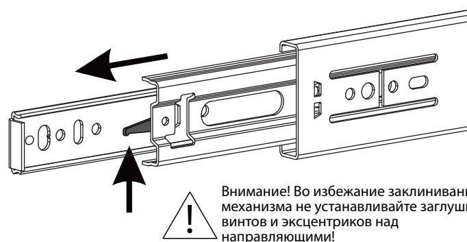
Схема установки шариковых направляющих.
