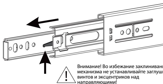
**Схема установки шариковых направляющих.**
